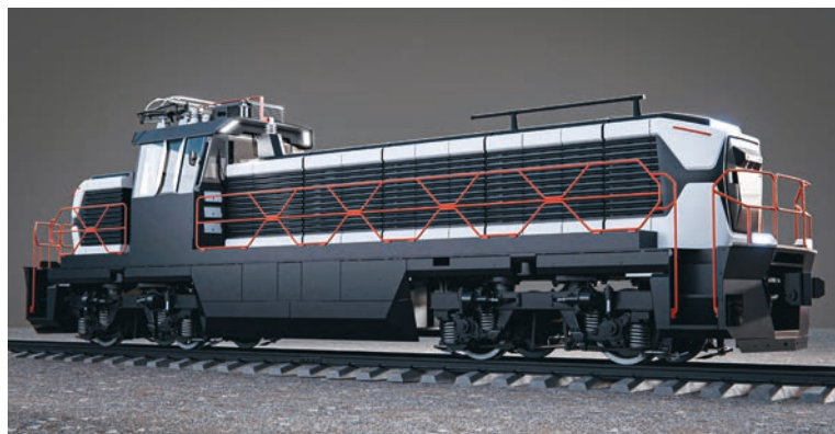
Перспективная разработка – контактно-аккумуляторный электровоз ЭМКА-2
