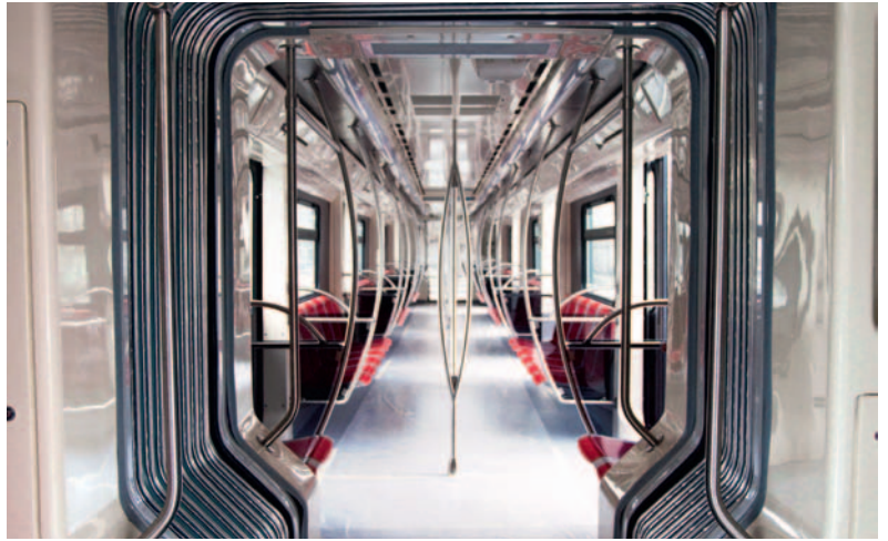
Рис. 4. Межвагонные переходы, позволяющие обеспечивать сквозной проход пассажиров по всему составу
