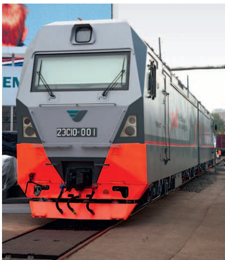
Грузовой электровоз постоянного тока 2ЭС10 с асинхронным тяговым приводом (слева)
