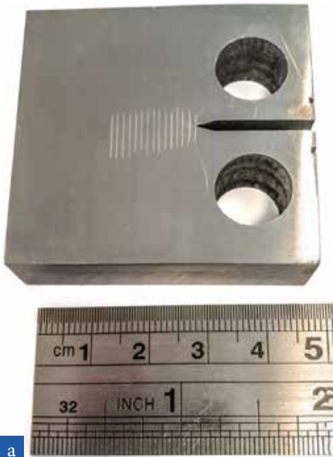
Рис. 1а. Внешний вид стандартного компактного образца на рост усталостной трещины
