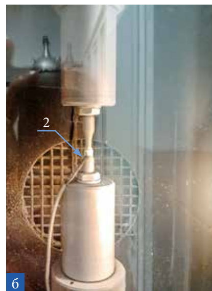
Рис. 4. Комплекс на базе машин Instron 8872 для усталостных испытаний (4а) и для усталостных испытаний с закреплением охлажденного образца (4б).
