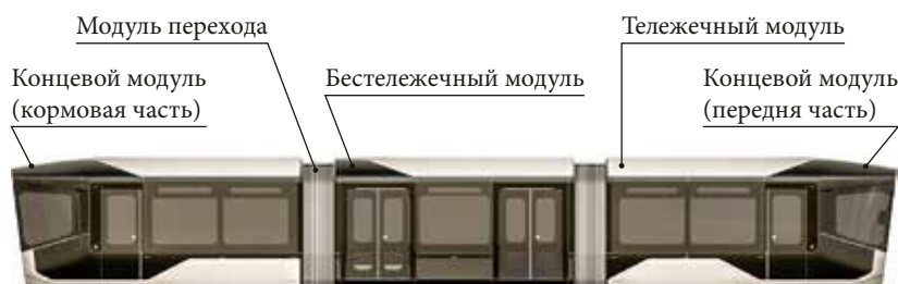
Рис. 2. Схема модульности трамвая 71-410 R1
