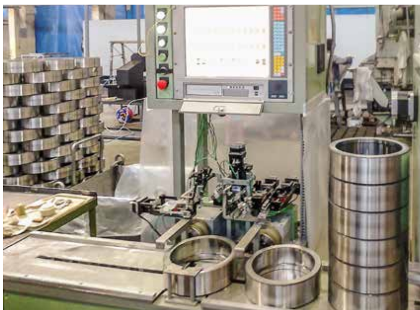
Рис. 1. Участок вихретоковой дефектоскопии наружных колец буксовых вагонных подшипников 42726, на котором применяется дефектоскоп последнего поколения модели АСВК-2НД
