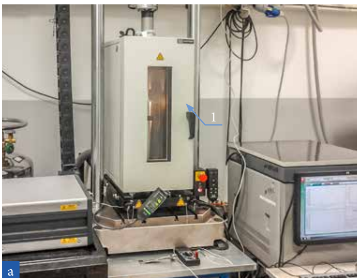
Рис. 4. Комплекс на базе машин Instron 8872 для усталостных испытаний (4а) и для усталостных испытаний с закреплением охлажденного образца (4б).
