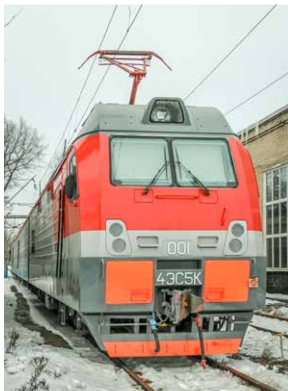
Рис. 1. Грузовой магистральный электровоз 4ЭС5К № 001
