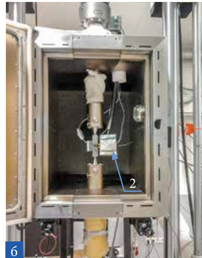
Рис. 2. Комплекс на базе машины Instron 8802 для усталостных испытаний (2а) и с термокамерой (2б).
