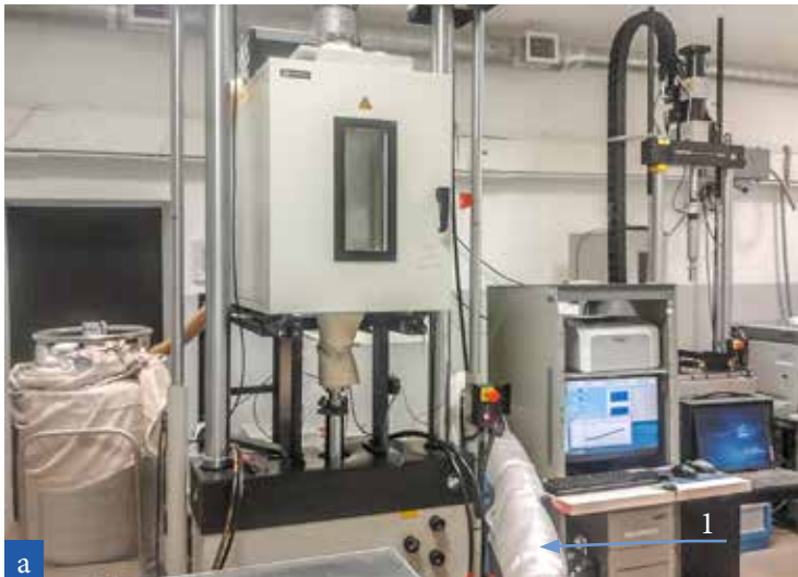
Рис. 2. Комплекс на базе машины Instron 8802 для усталостных испытаний (2а) и с термокамерой (2б).
