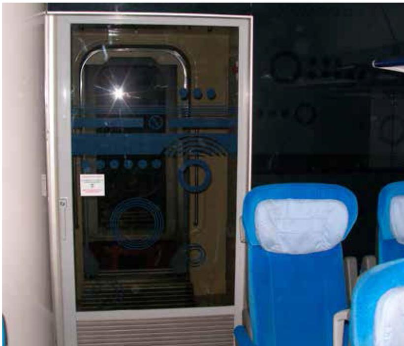
Рис. 6. Торцевая стена и сдвижные двери
