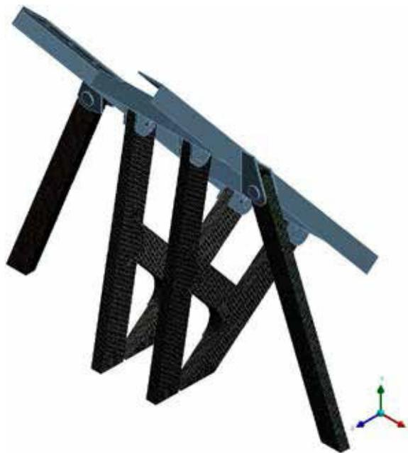
Рис. 5б. Расчетные конечно-элементные модели раскосов торцевых стен вагона-хоппера
