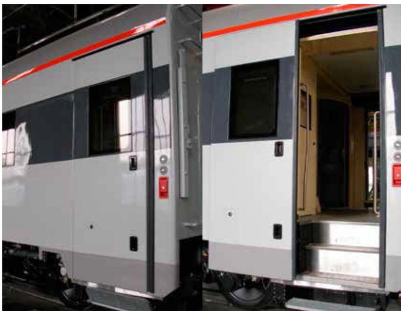
Рис. 9. Двери входные наружные (положение «открыто/закрыто»)
