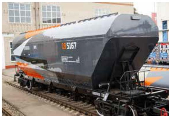
Рис. 10. Общий вид опытного образца вагона-хоппера модели 19-5167
