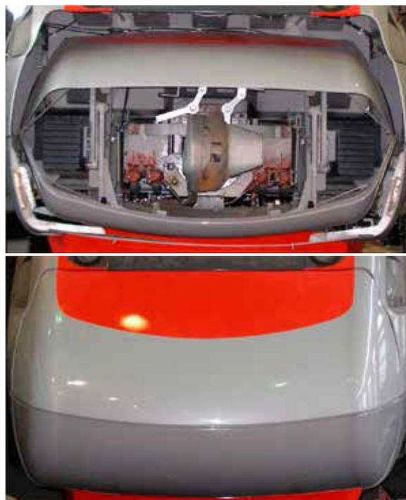
Рис. 4. Передняя открываемая часть обтекателя (режим «закрыто/открыто»)
