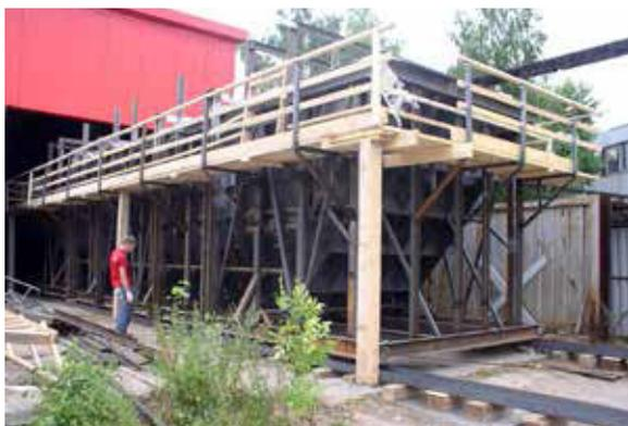
Рис. 8. Изготовленная формообразующая оснастка основания кузова вагона-хоппера
