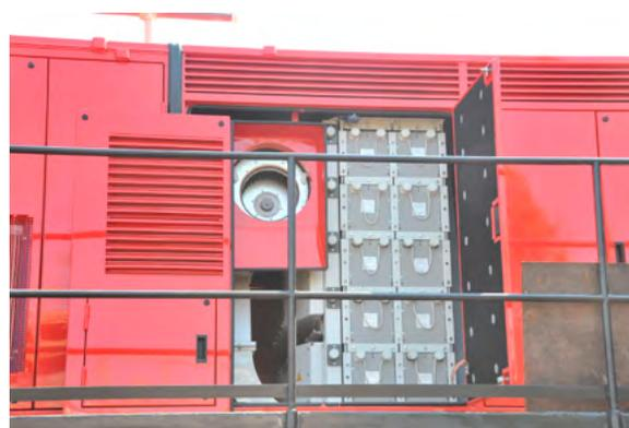
Рис. 2. Электрохимические конденсаторы
