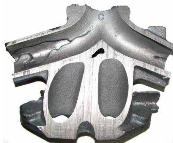
Рис. 7. Фрагмент верхней внутренней части отливки «Коллектор» с протоками металла в объеме газовой раковины
