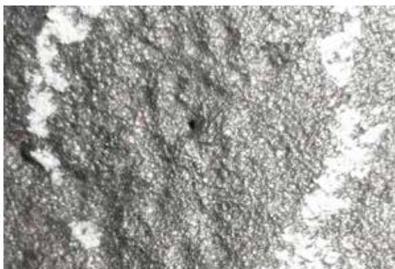
Рис. 3. Фрагмент участка отливки «Рама боковая» с еле заметной окисленной газовой раковинной
