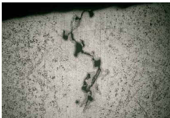
Рис. 4б. Фотография протяженного дефекта, полученная под увеличением в 100х
