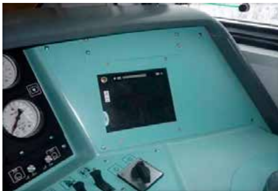
Рис. 3. Телеметрическая система контроля бодрствования машиниста
