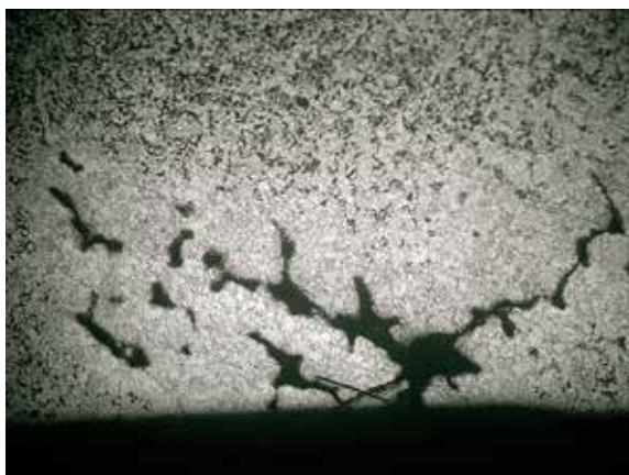
Рис. 5. Дефект отливки «Рама боковая», аналогичный рассматриваемому на рис 4, но имеющий другую, более разветвленную форму
