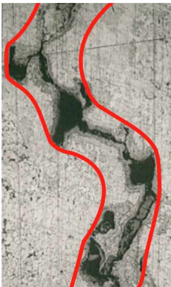
Рис. 6. Наложение очертания начального потока входящего в расплав стали газа на затвердевшее очертание остаточной газовой раковины
