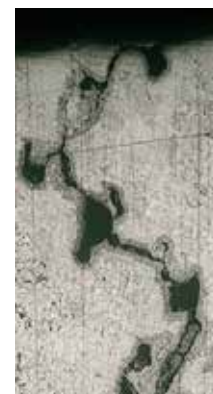
Рис. 4в. Увеличение протяженного дефекта в 200х
