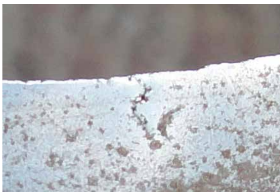
Рис. 4а. Макрошлиф с протяженным дефектом, идущим от поверхности отливки в зоне радиуса R55
