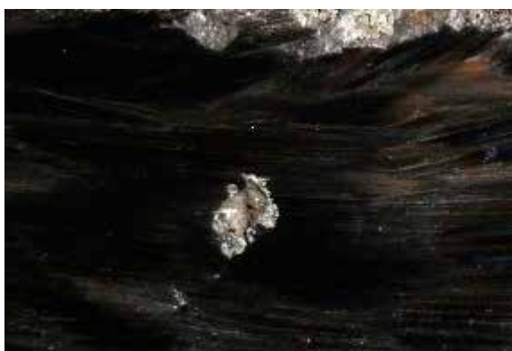
Рис. 2в. Увеличенный фрагмент участка отливки с точечным отверстием в центре окисленной газовой раковины
