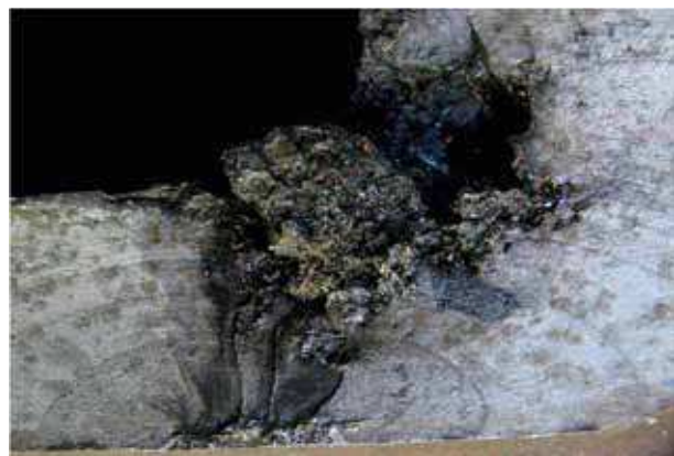
Рис. 4. Поверхность излома отливки с газовой раковинной и землей
