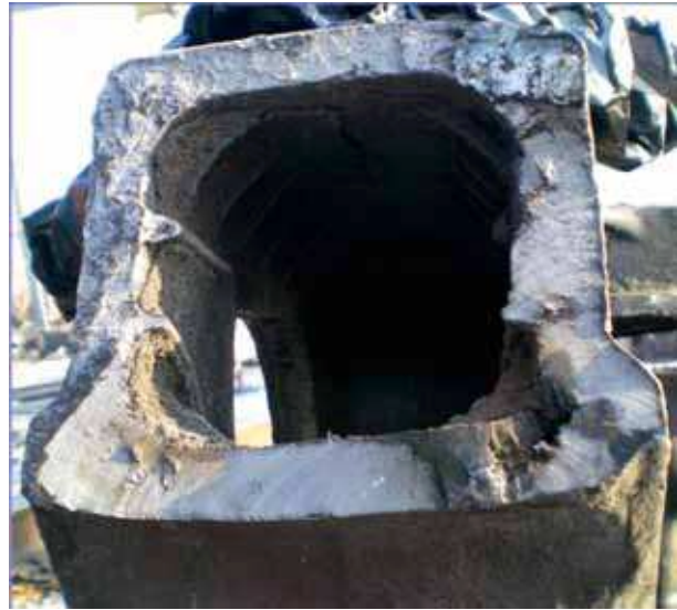
Рис. 3. Поверхность излома отливки с шлаковыми включениями
