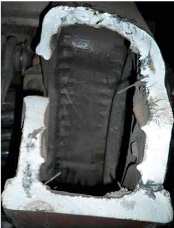
Рис. 2. Поверхность излома отливки с газовой и усадочными раковинами
