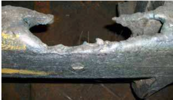
Рис. 5. Верхняя часть отливки с недоливом
