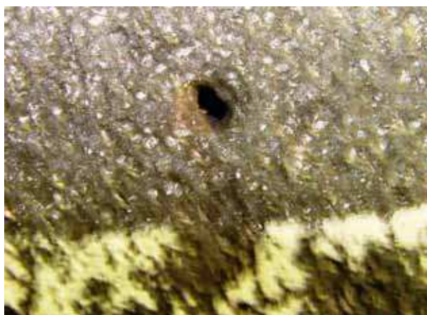
Рис. 6. Поверхность отливки с газовой раковинной
