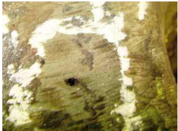
Рис.7. Поверхность отливки с раковинной на изломе прибыли
