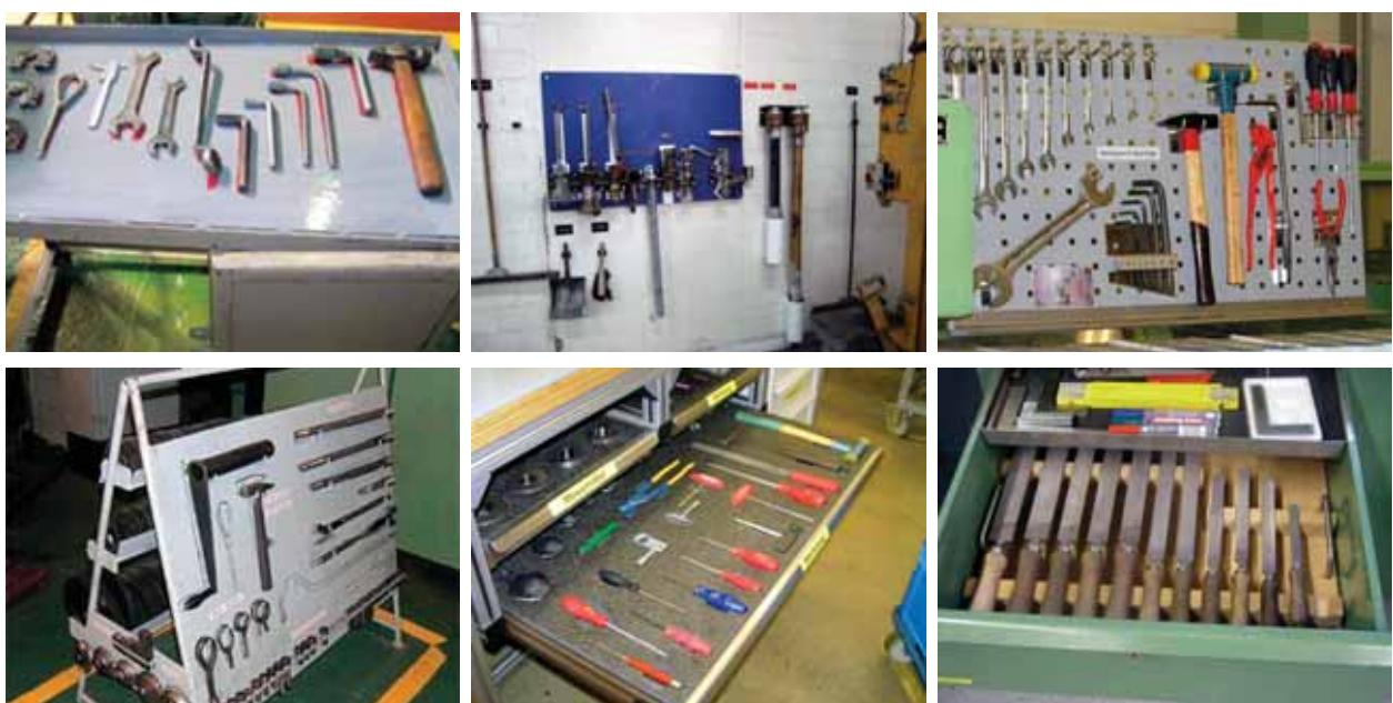
Рис. 2. Примеры рационального расположения инструментов и оснастки
