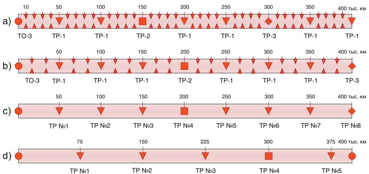
Рис.2. Варианты норм периодичности и виды технического обслуживания и ремонта локомотивов в пределах гарантийного периода эксплуатации (20 месяцев — 400 тыс. км пробега) при  $L_m = 20$  тыс. км
