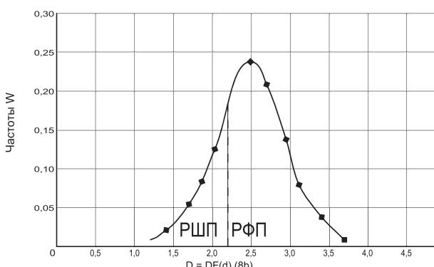
Рис. 2. Эмпирическое (репреобразованное) (8a) и преобразованное (8b распределение) глубин неровностей  $d_{mm}$ , частот  $W$  на поверхности катания рельсов
