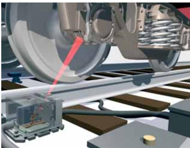
Рис. 8. Автоматизированная система контроля нагрева бокса подвижного состава
