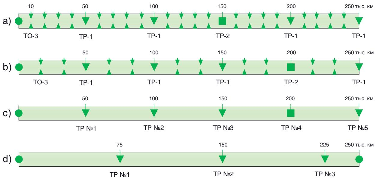
Рис.1. Варианты норм периодичности и виды технического обслуживания и ремонта локомотивов в пределах гарантийного периода эксплуатации (24 месяца — 250 тыс. км пробега) при  $L_m = 10$  тыс. км
