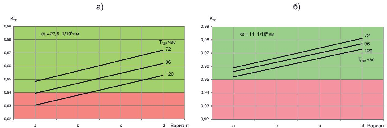
Рис.3. Расчетные значения  $K_{TT}$  грузовых локомотивов за периоды приработки (а) и нормальной эксплуатации (б) при различных вариантах СТОР и нормативном  $T_{пл}$  ( $L_m = 10$  тыс. км)
