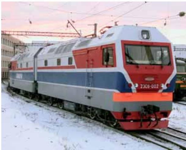
Рис. 4. Грузовой электровоз постоянного тока 2ЭС6
