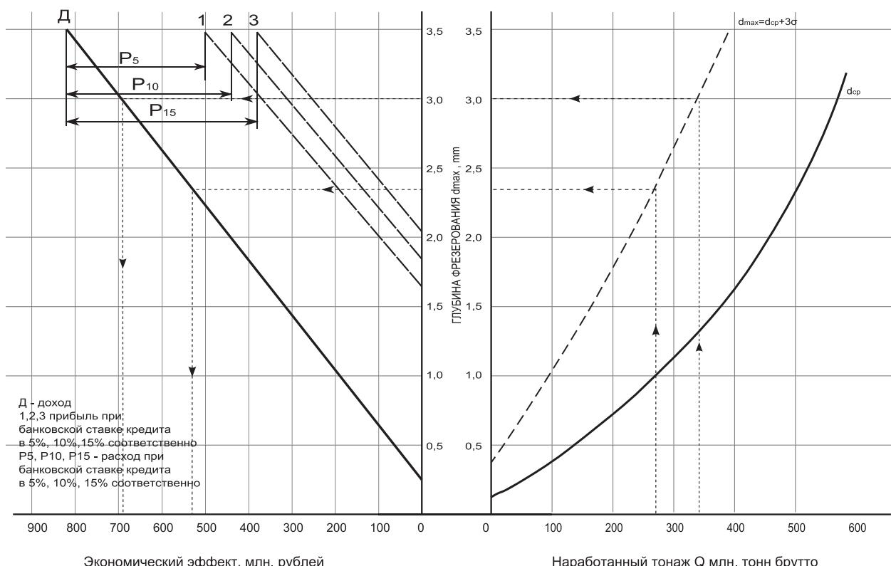
Рис. 3. Номограмма определения технико-экономических параметров технологии фрезерования рельзов в пути.
