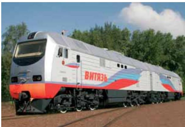
Рис. 5. Грузовой тепловоз с асинхронным тяговым приводом 2ТЭ25А
