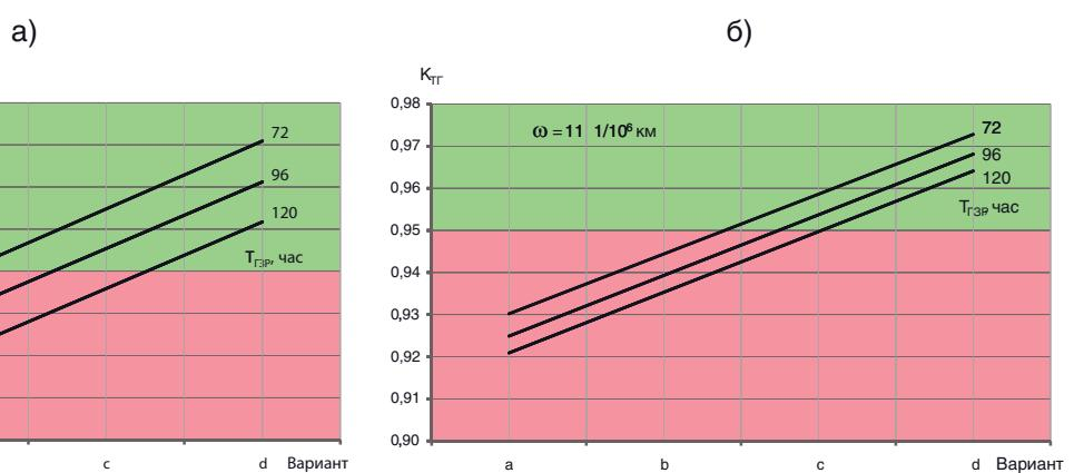
Рис.5. Расчетные значения  $K_{\text{TR}}$  грузовых локомотивов за периоды приработки (а) и нормальной эксплуатации (б) при различных вариантах СТОР и увеличенном  $T_{\text{пл}}$  ( $L_M = 10$  тыс. км)
