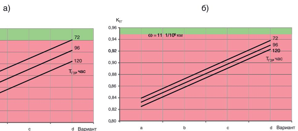
Рис.6. Расчетные значения  $K_{\text{TR}}$  грузовых локомотивов за периоды приработки (а) и нормальной эксплуатации (б) при различных вариантах СТОР и увеличенном  $T_{\text{пл}}$  ( $L_M = 20$  тыс. км)
