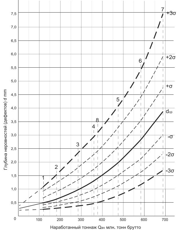
Рис. 1. Стохастическая зависимость изменения глубины неровностей (дефектов)  $d$  мм на поверхности катания рельсов в зависимости от наработанного тоннажа  $Q$  млн тонн брутто
