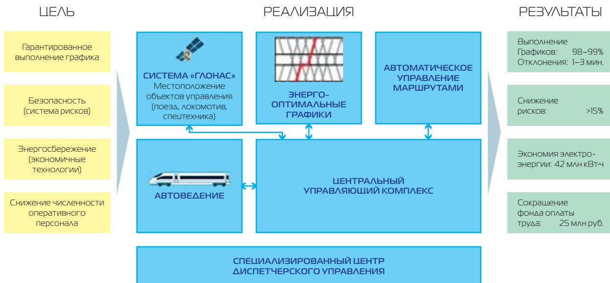
Рис. 7. Автоматизированный программно-технический комплекс управления движением поездов на направлении Санкт-Петербург – Москва
