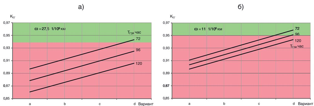
Рис.4. Расчетные значения  $K_{TT}$  грузовых локомотивов за периоды приработки (а) и нормальной эксплуатации (б) при различных вариантах СТОР и нормативном  $T_{пл}$  ( $L_m = 20$  тыс. км)
