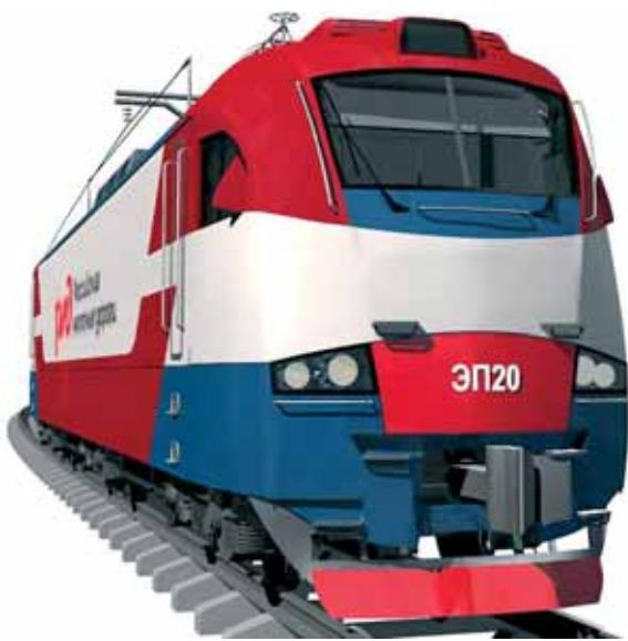
Рис. 3. Пассажирский электровоз двойного питания с асинхронным тяговым приводом ЭП20
