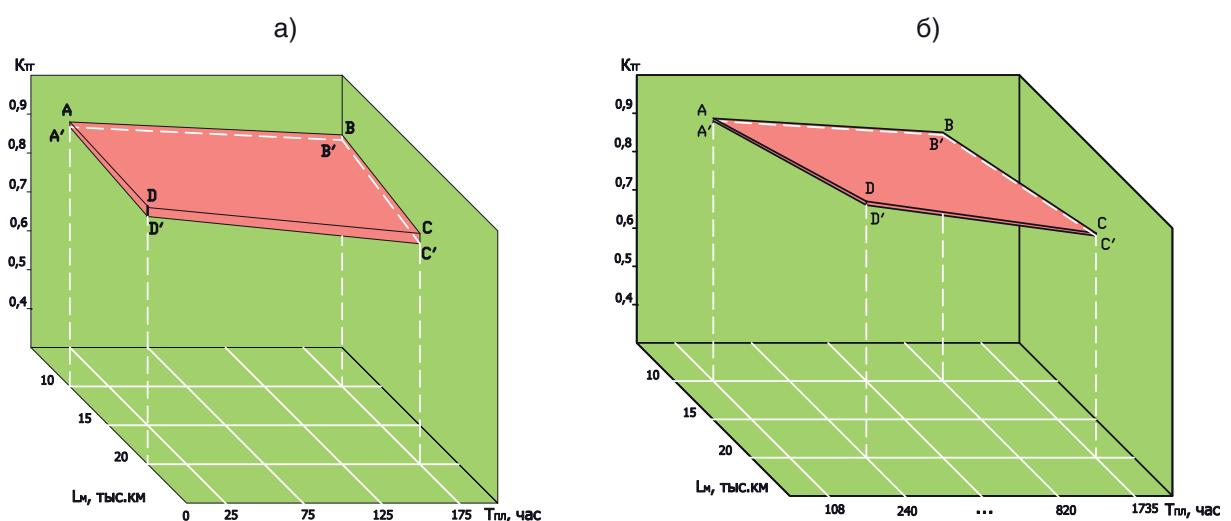
Рис.7. Возможные значения  $K_{\text{ГР}}$  грузовых локомотивов, соответствующих требованию по безотказности, за периоды приработки (а) и нормальной эксплуатации (б)
