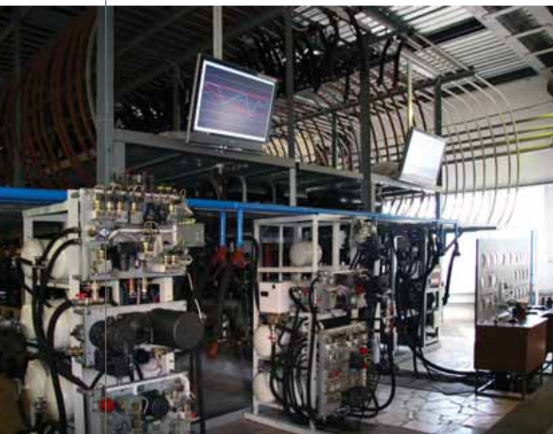
Групповой стенд для испытания тормозного оборудования
