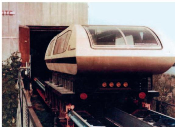
Рис. 5. Испытания вагона ТП-05 массой 18 т с ТЛЭП с опорой на систему магнитного подвеса
