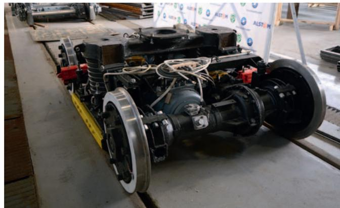
Рис. 3. Тележка 13Т00М (после модернизации)
