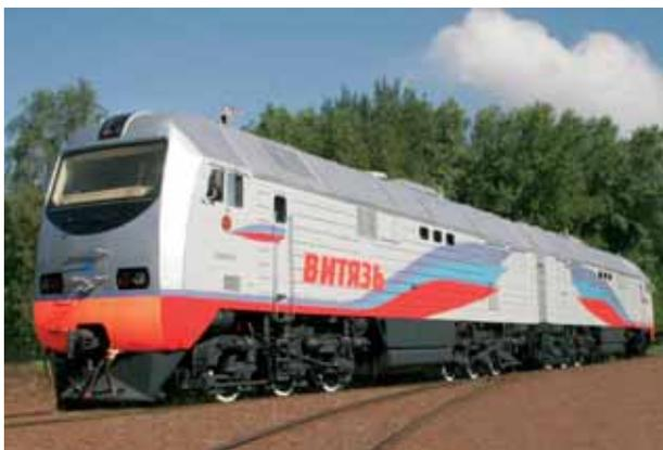
Рис. 5. Грузовой тепловоз с асинхронным тяговым приводом 2ТЭ25А
