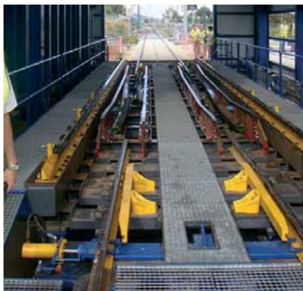
Рис. 1. Переводное устройство для изменения ширины колеи 1520 мм / 1435 мм
