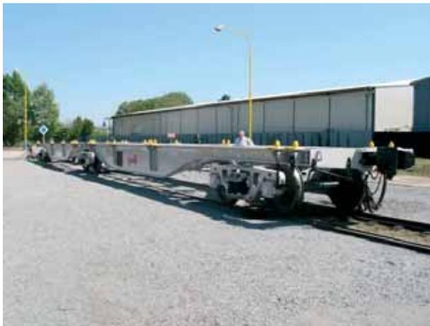
Рис. 6. Вагон-платформа сочлененного типа для перевозки крупнотоннажных контейнеров
