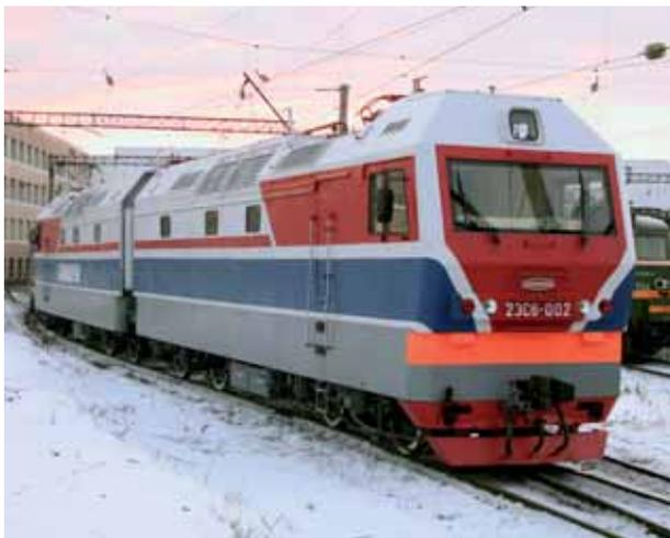
Рис. 4. Грузовой электровоз постоянного тока 2ЭС6
