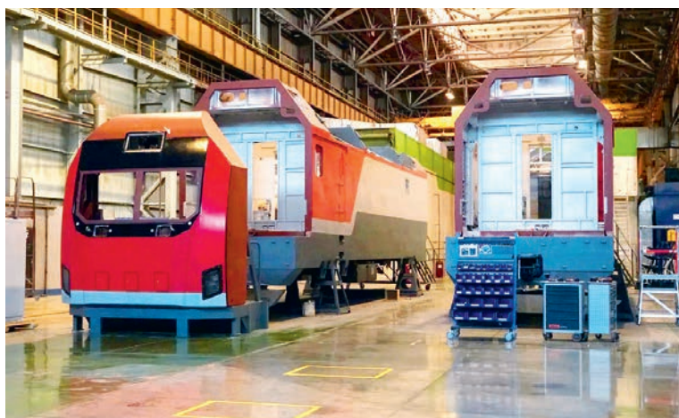
Форма фронтальной части кабины машиниста с интегрированной крэш-системой
