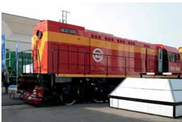
**Четырехосный маневровый тепловоз средней мощности с электрической передачей и индивидуальным приводом колесных пар**
