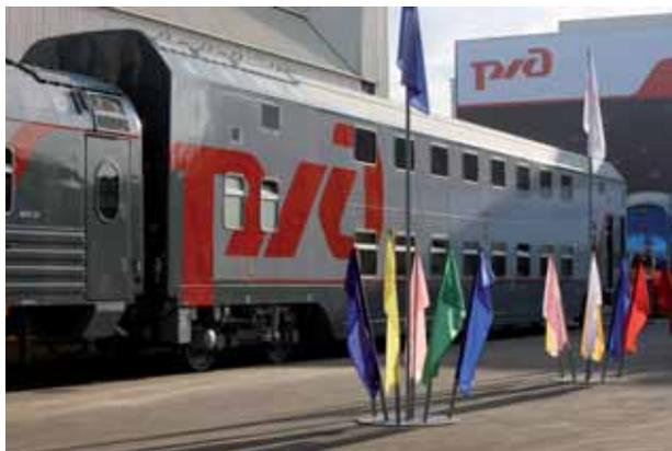
**Пассажирский двухэтажный вагон** (опытный образец). Производство — ОАО «Тверской вагоностроительный завод». Создан в соответствии с техническим заданием ОАО «РЖД». Рассчитан на 64 места, расположенных в 16 купе. Предназначен для движения на скоростях до 160 км/ч, кузов изготавливается из коррозионно-стойких сталей.
