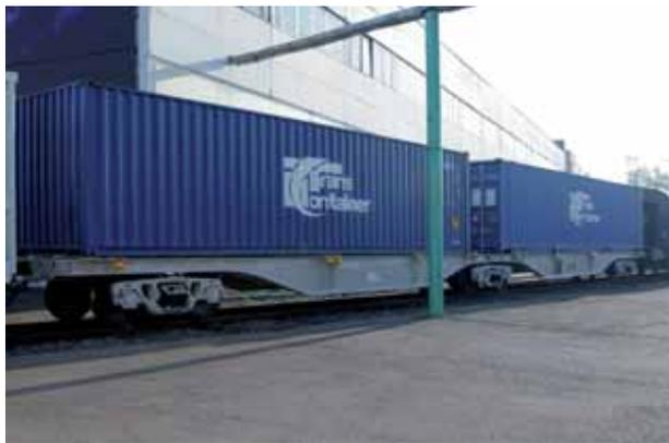
**Вагон Sggmrss 90.** Производство — АО «Татравагонка» (Словакия). Опытный образец 6-тиосной платформы сочлененного типа для перевозки крупнотоннажных контейнеров.
