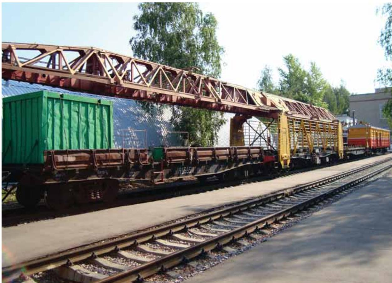
Рис. 8. Испытания энерговагона совместно с укладочным краном УК25-18/9
