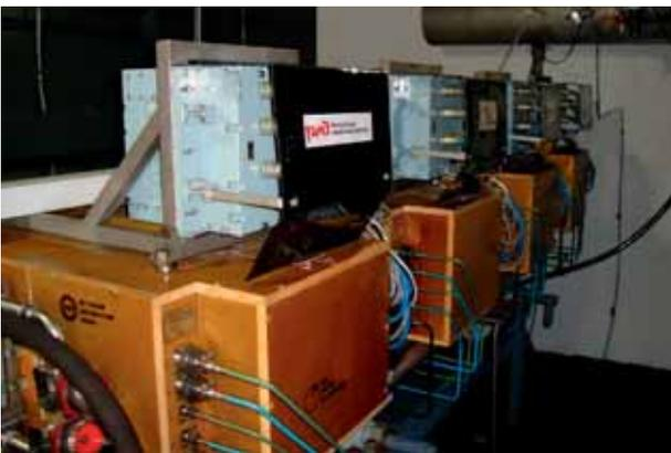
Рис. 5. Электрохимические генераторы на топливных элементах «Фотон» в энергетическом вагоне
