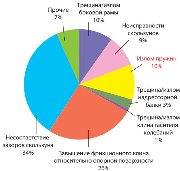
Рис. 1. Отцепки в TOP грузовых вагонов по неисправности тележек за 2010 год
