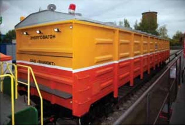
Рис. 4. Вагон с энергетической установкой на топливных элементах
